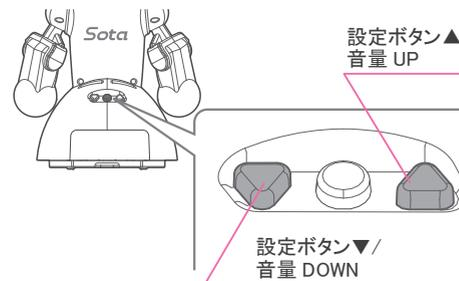
01. 背面側の設定ボタンの▲▼を同時に長押し（約3秒間）して「設定モード」に移行します。
